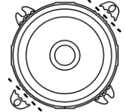
図-2 長穴取付部の2カ所を切り取ります。
